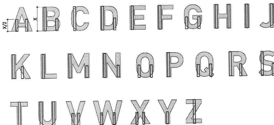
Figura 20 – Posicionamento do suporte metálico nas letras caixa Elaboração: CEPED/UFSC (2022)
