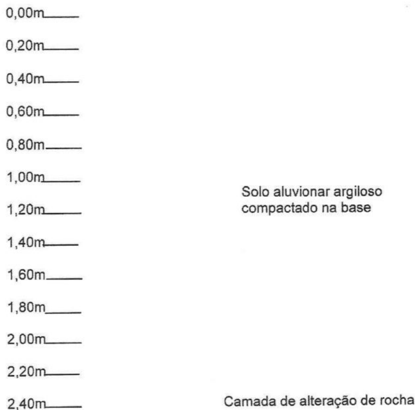
Fig. 04: Perfil esquemático em S 05, na margem Direita com profundidade de 2,30m.
