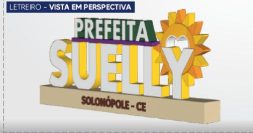
LETREIRO COM ESTRUTURA EM TUBOS METÁLICOS GALVANIZADOS REVESTIDOS EM ACM (ALUMÍNIO COMPOSTO) NAS CORES RESPECTIVAS AO PROJETO ILUSTRATIVO, CONTENDO BASE EM CONCRETO ARMADO.
