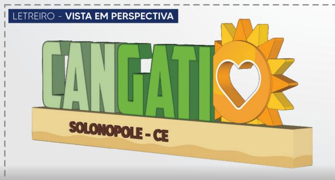
LETREIRO COM ESTRUTURA EM TUBOS METÁLICOS GALVANIZADOS REVESTIDOS EM ACM (ALUMÍNIO COMPOSTO) NAS CORES RESPECTIVAS AO PROJETO ILUSTRATIVO, CONTENDO BASE EM CONCRETO ARMADO.
